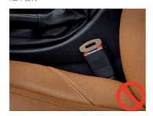
发生事故时,车辆电脑系统可能会据此认为乘员此时已系好安全带,并且在具备气囊启爆条件时激活气囊。气囊被启爆的瞬间爆发力极大,未系安全带且因惯性而用力前驱的乘员的头部、颈部与该爆发力相撞极可能受到严重伤害。所以我们强烈建议您正确使用和佩戴安全带。另外如随意对安全带进行改装或改动,或调整车辆的其它配置,均有可能取消"安全带未系"提示音。当车辆出现旋转或者翻滚时,安全带是确保车辆驾乘人员不被甩出车外造成严重伤害的最有效措施。气囊无法起到相同作用。
