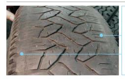
气压不足会导致轮胎胎面两边胎肩过度磨损。轮胎都有正常的使用寿命(里程数)。但是如果轮胎充气气压不正确或车辆有其它机械问题,会使轮胎出现不规则磨损,从而加快轮胎的正常磨损。
