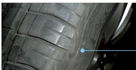
由于汽车在行驶中,轮胎胎肩或接近胎肩的胎边部位强烈撞击外物,导致轮胎在轮辋凸缘和冲击物之间产生严重挤压,胎体帘子线因过度拉伸而断裂,从而出现胎侧鼓包现象。
