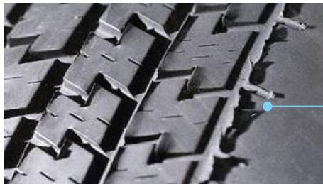
车轮定位不良造成的羽状边磨损。
